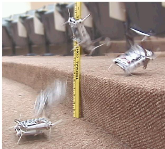
Fig.2-8 Jumping motion of the mini Whegs
