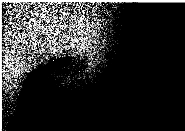
写真6.2 Ag-Cuの接合界面の溶融層
