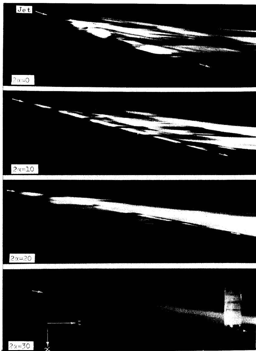
写真3.6 Al-Al対称衝突におけるジェット速度を測定するための流レカメラ像
