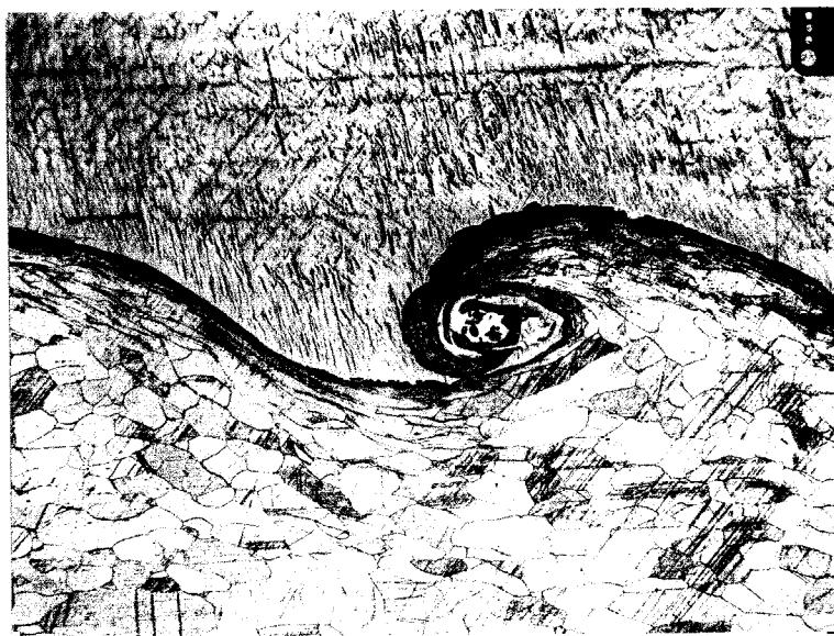
写真3.18 Ti-Feの接合界面の波形
