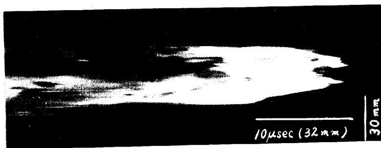
写真 3.5 超高速流シカメラによって撮影した Al-Al 対射衝突のジェット形状 (ジェットのみ撮影) (スリット位置 Y-Y')
