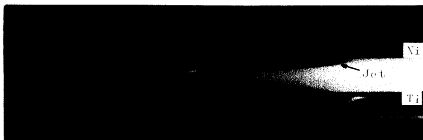
写真 3.9 超高速流カメラにより撮影した Ni-Ti の ジェット形状
