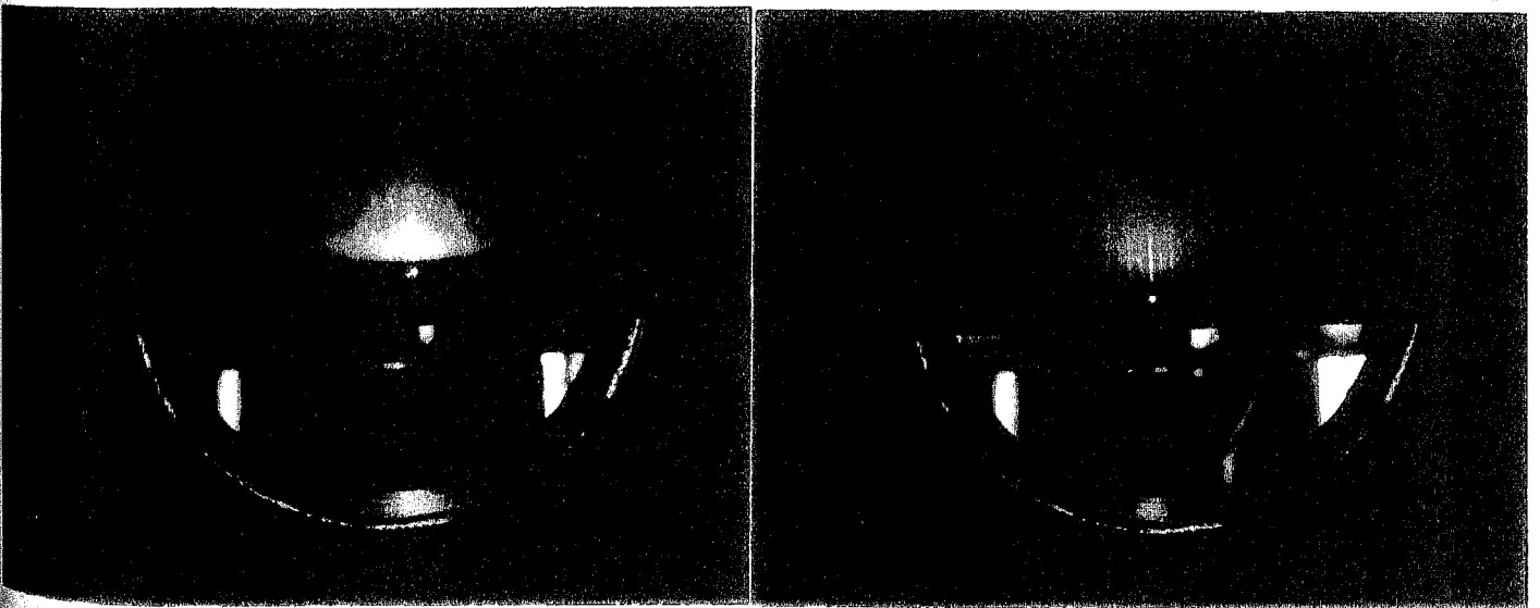
図4-21 Si(111)基板上に作製した試料に対する RHEED 像。電子線の入射方向は \langle 112 \rangle 方向。(a)は BaMgF 4 膜堆積前の RHEED 像、(b)は BaMgF 4 膜堆積後の RHEED 像。
