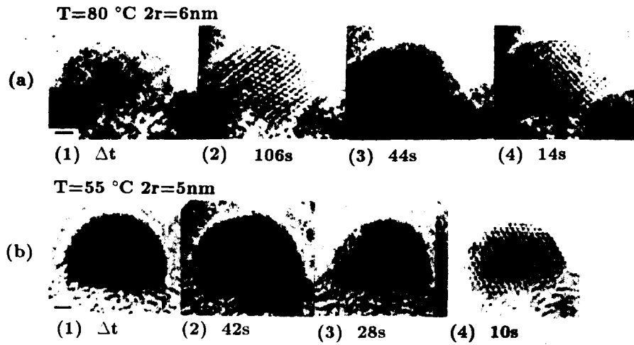
図3.10 やや小さい固相粒子の動的変化の高分解能像
