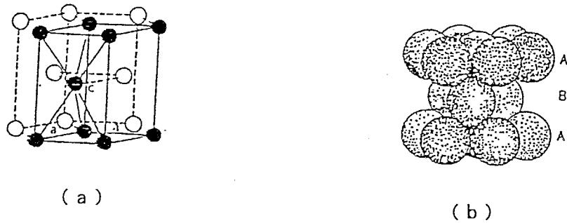
図 6-48: hcp (六方最密格子) 構造のモデル図 (a)hcp 構造の単位格子 (b) 最密面方向の結晶構造
