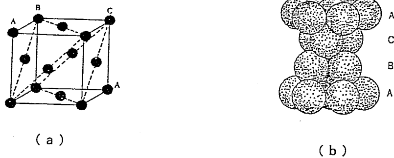
図 6-47: fcc (六方最密格子) 構造のモデル図 (a)fcc 構造の単位格子 (b) 最密面方向の結晶構造
