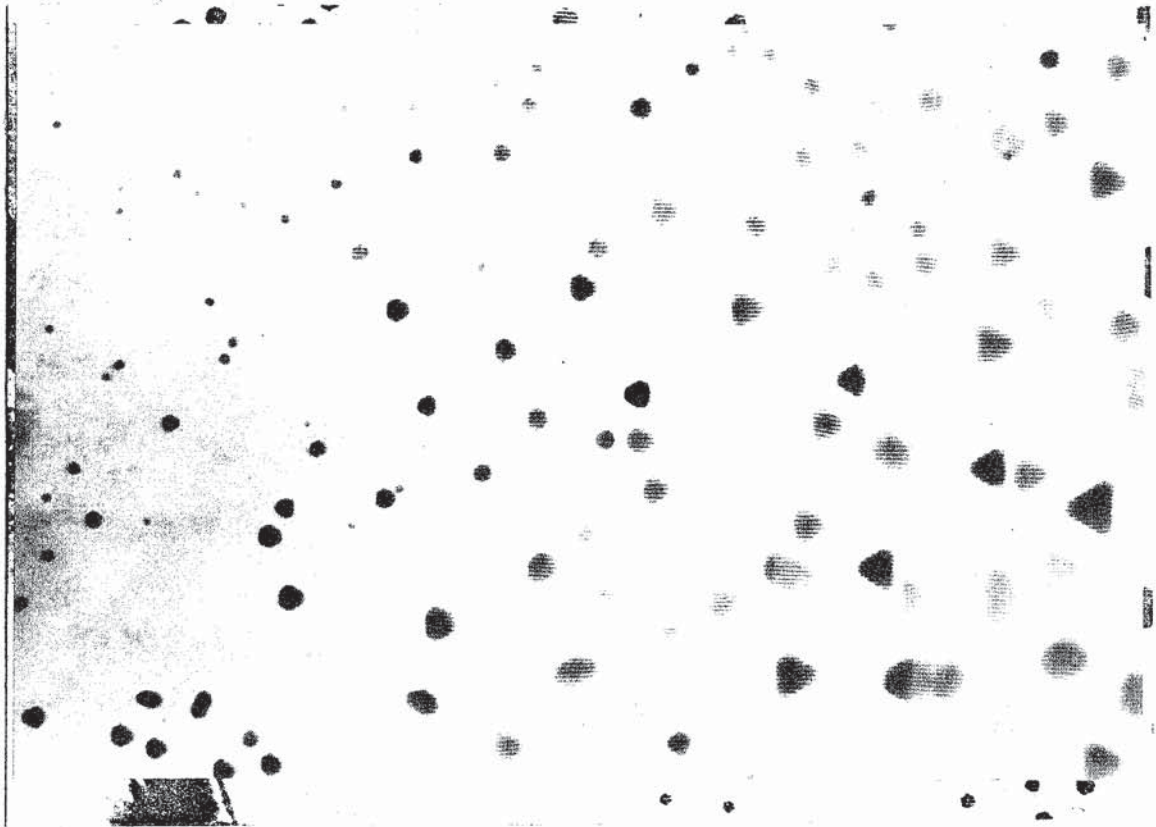
図5-12 300 °C の \text{MoS}_2 上に成長した Au 粒子の粒子径分布 粒子中のモアレ縞は \sim 17 \text{ \AA} 間隔で, \text{Au}(220) と \text{MoS}_2(11\bar{2}0) 反射による。方位は (111)_{\text{Au}} // (00\cdot1)_{\text{MoS}_2} , [110]_{\text{Au}} // [11\bar{2}0]_{\text{MoS}_2} であり, 右向きと左向きの三角形は ( ) かわゆる Double Positioning の関係にある。視野中に, 10 \text{ \AA} \sim 200 \text{ \AA} 程度の粒子径分布が得られていることに 注目。
