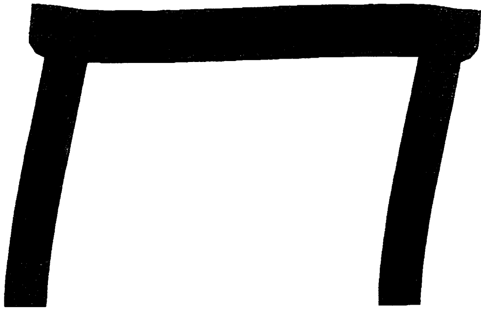
(a) 1次モード(固有振動数 f_1=1.6750\text{Hz} )
