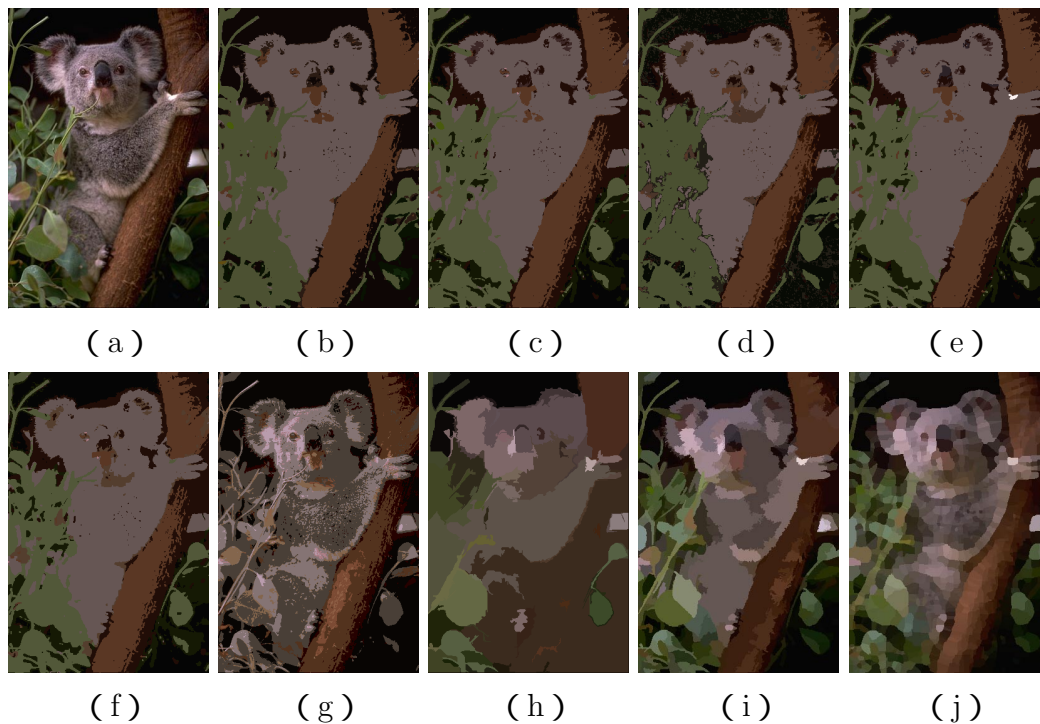
図 5.2 提案手法および従来手法による画像分割 (1) (a) 原画像 (b) から (d) は提案モデルに対する MPM 推定値でありそれぞれ, 次数を L = 10 , L = 15 , L = 20 とした (e) および (f) は提案モデルに対する MAP 推定値でありそれぞれ, 次数を L = 10 , L = 15 とした (g) ファジィc-平均法 [62] (h) グラフに基づく手法 [33] (i) 平均値シフトアルゴリズム [24] (j) ウォータシェッド法 .
