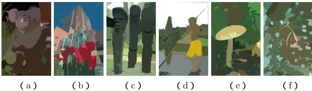
図 2.5 グラフ理論による画像分割 [33] . パラメータは \sigma = 0.8 , k = 300 とした . 入力画像は 23 の領域に分割された .
