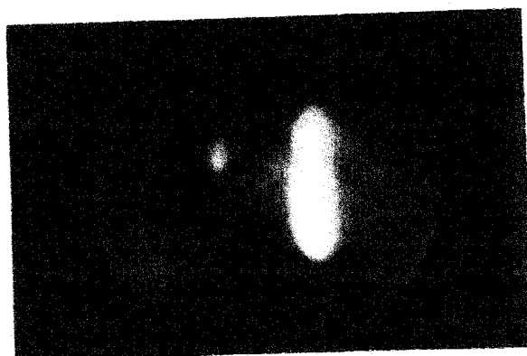
第5.33圖 高感度検出装置による LiF単結晶の回折記録 左から (200)Kβ, (200)Kα
