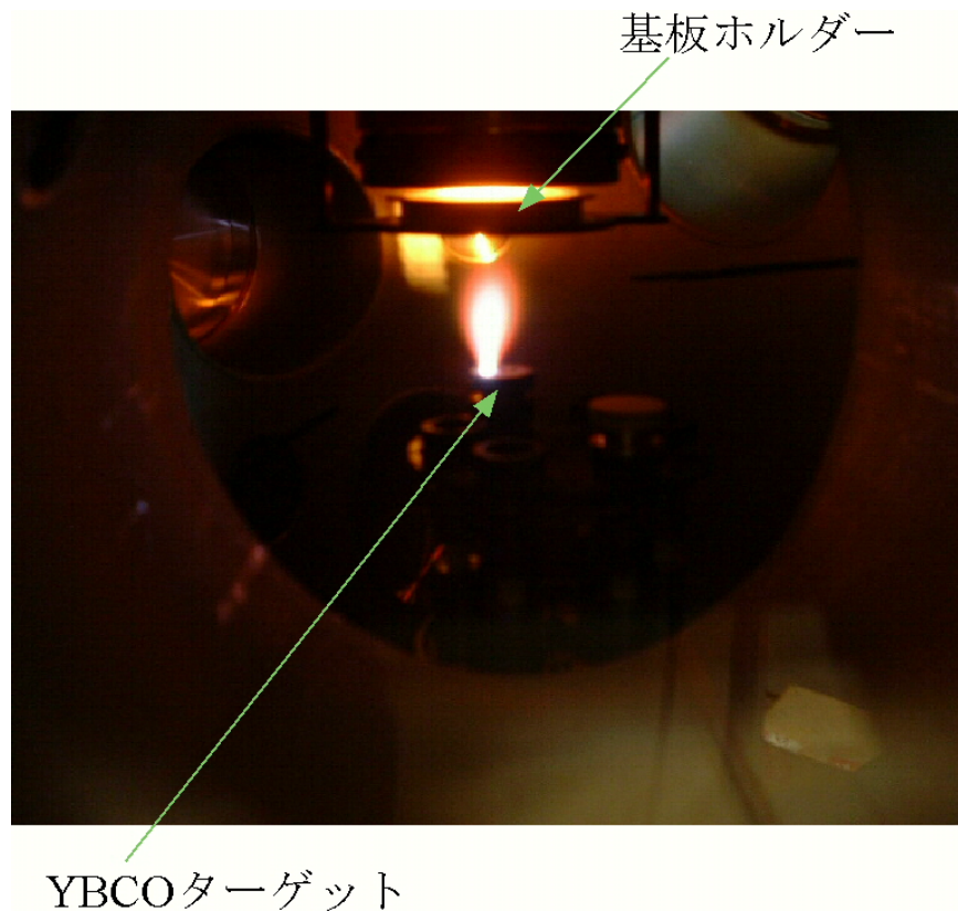
図 4.1: PLD 法による YBCO の成膜の様子
