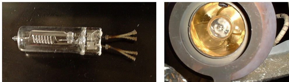
図 4.6: ランプヒータの写真。単体 (左) とセットされた状態を下から見たもの (右)
