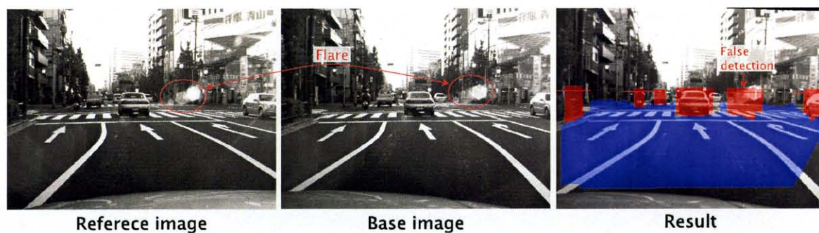
図 4.22: フレアによる誤検出例 Fig. 4.22: False detection example for flare.
