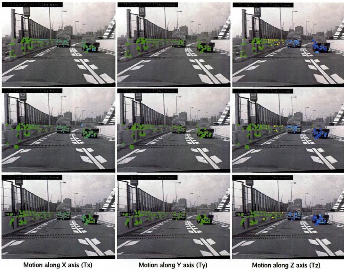
図 6.23: 障害物の絶対モーション推定結果. 1 フレームおきの結果を表示 Fig. 6.23: Estimated obstacle's absolute motion. These results are taken every 2 frame.
