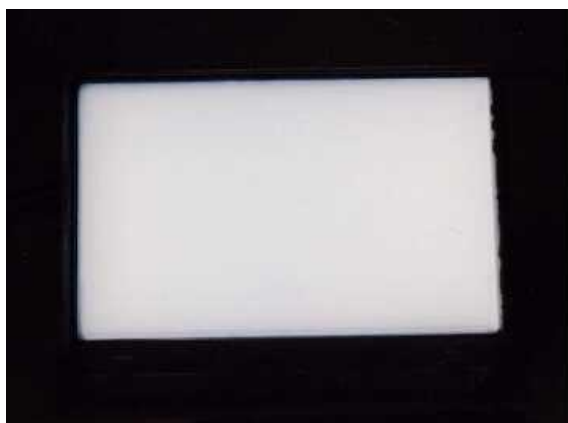
図 7-1 8.5 インチサイズ平面形誘電体バリアマイクロ放電光源
