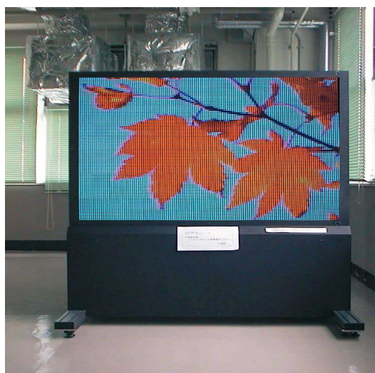
図 7-3 放電パネルで構成した 64 インチ大形表示装置
