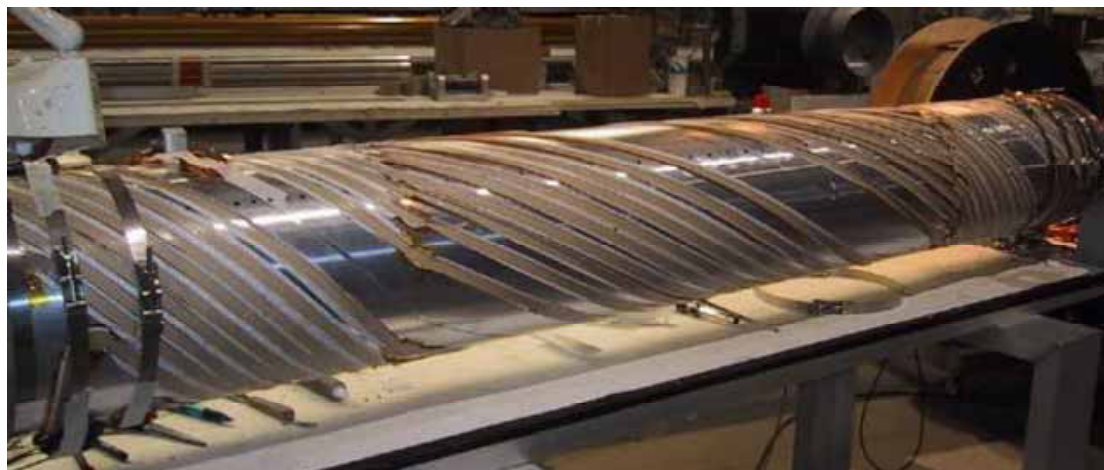
図 6-2-2 : 製作中の超伝導ヘリカルコイル
