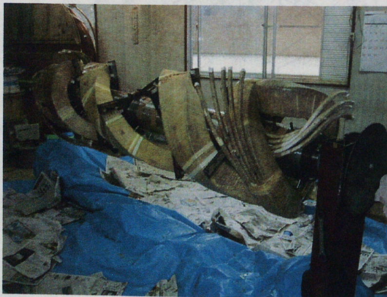
図 AP4-2: エポキシ樹脂で固められているヘリカルコイル
