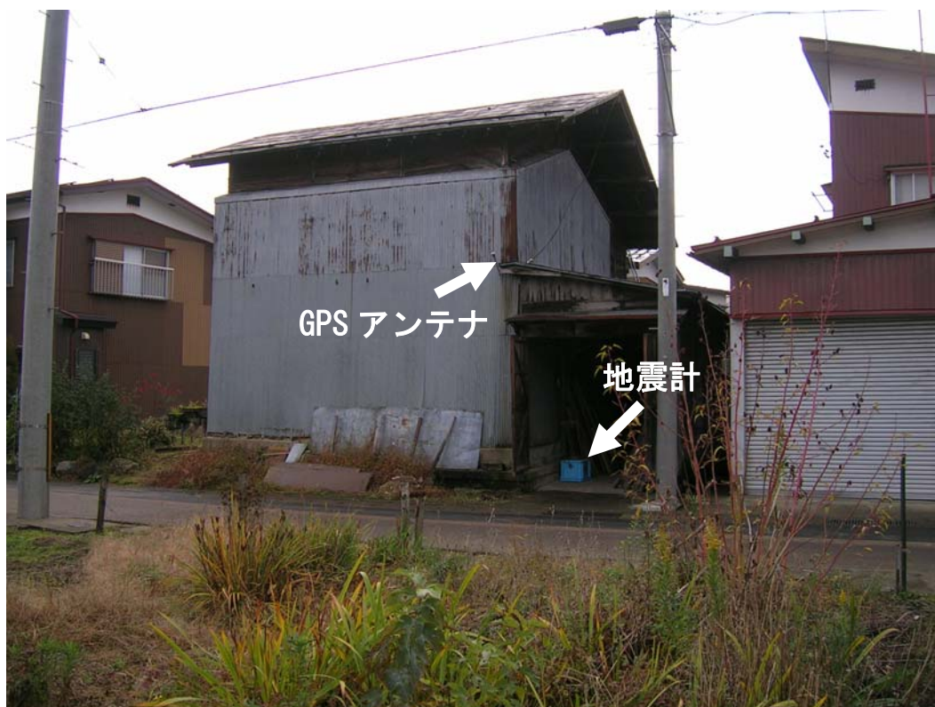
写真 4. 3. 3-6 地震計設置地点 (No. 1 地点、土川 1 丁目)
