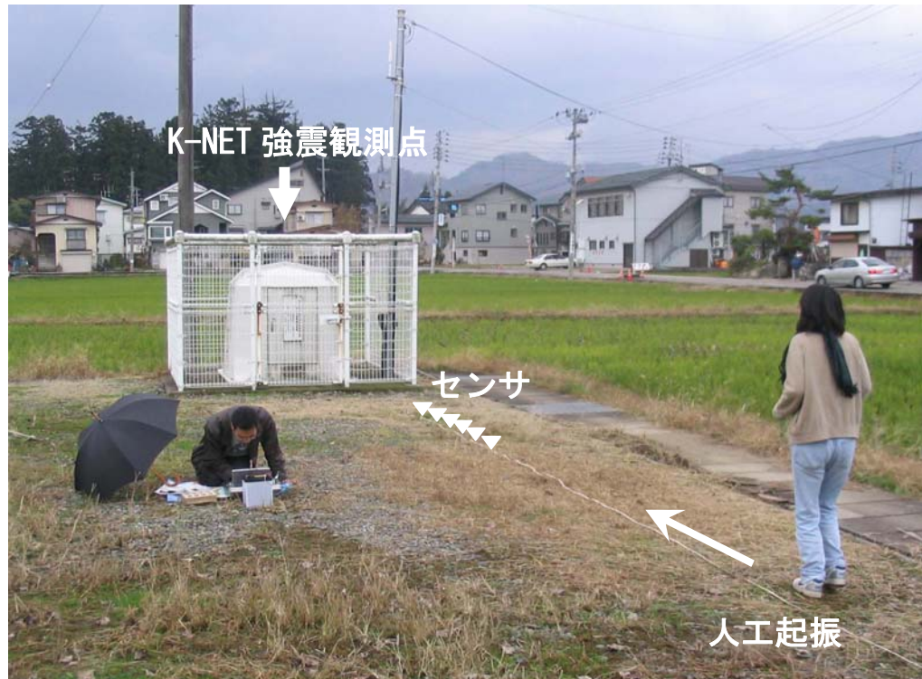
写真 4. 2. 2-1 強震観測点での表面波探査（K-NET）
