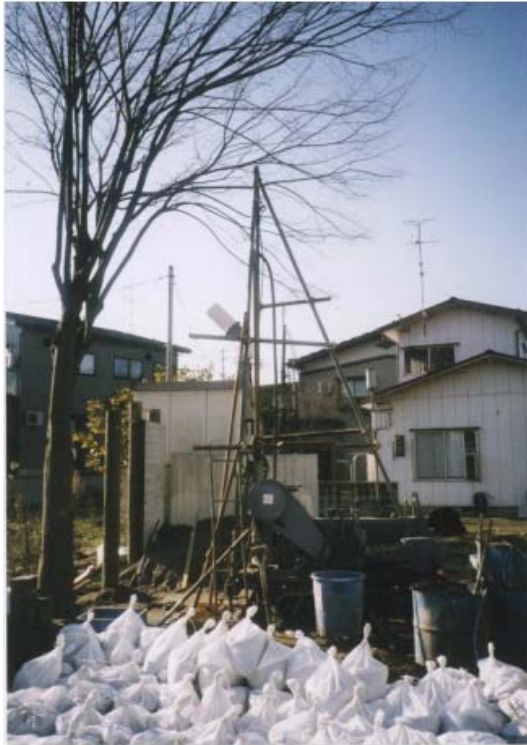
写真 2.3.1 (2) ボーリング・PS 検層の実施状況 (JMA)
