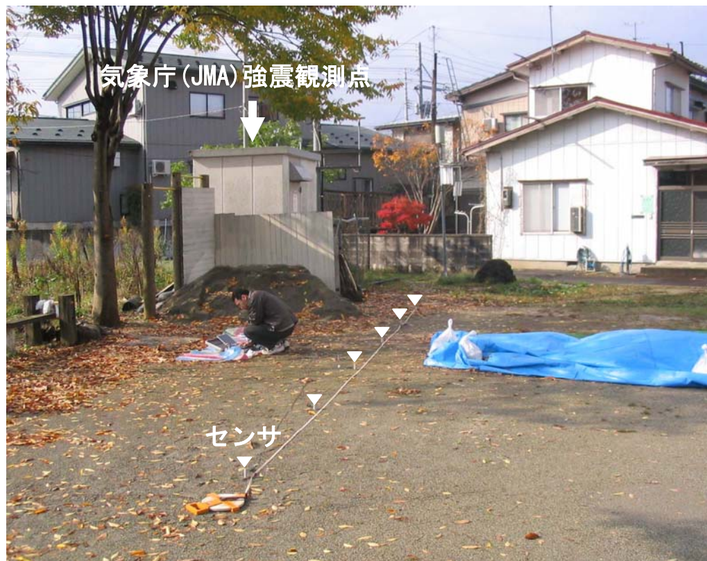
写真 4. 2. 2-2 強震観測点での表面波探査（JMA）
