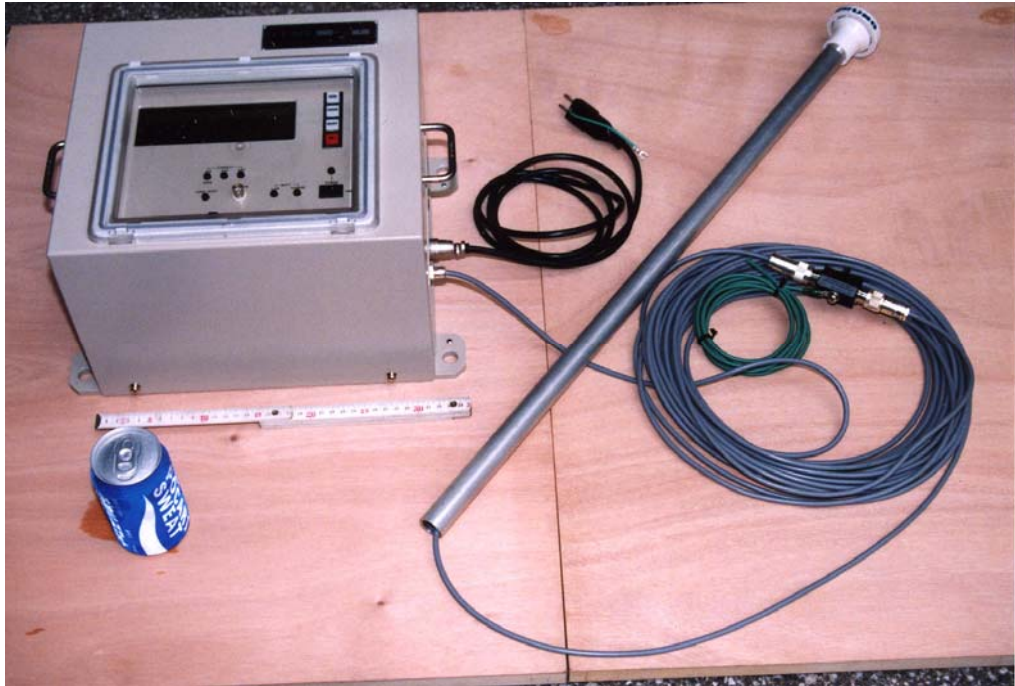
写真 4.3.1 地震計と GPS アンテナ
