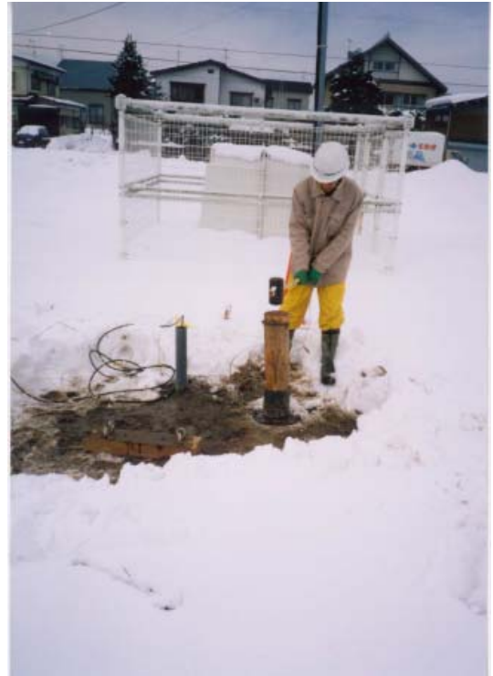
写真 2.3.1 (1) ボーリング・PS 検層の実施状況 (K-NET)
