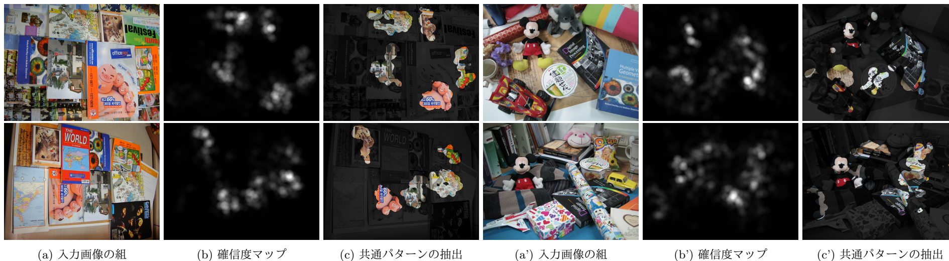
図9 入力画像, 共通パターンの確信度マップおよび, 共通パターン抽出結果.
