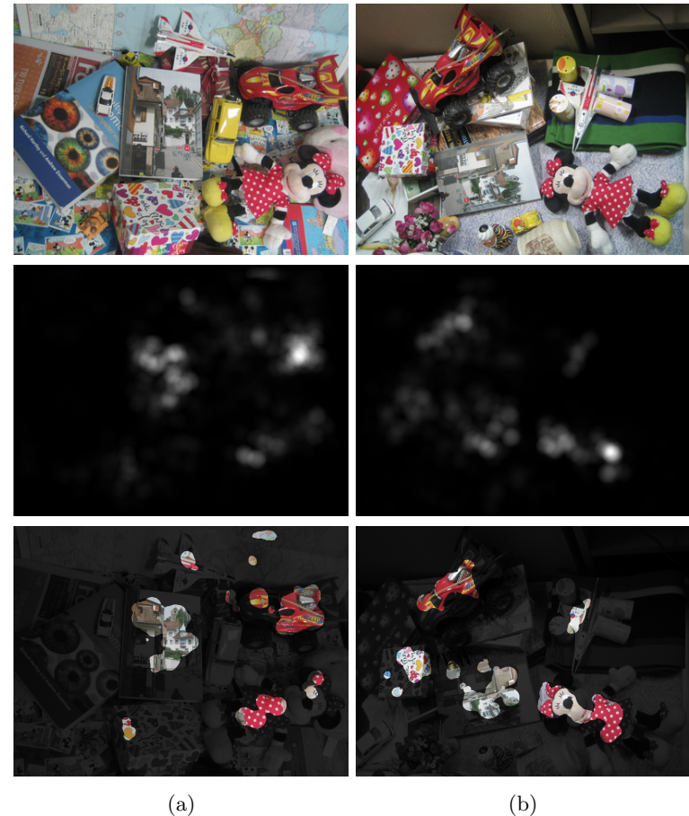
図 7 共通パターンの確信度マップ (中段) および、共通パターン抽出結果 (下段). Fig. 7 Confidence map for common visual patterns (middle) and segmentation result (bottom).
