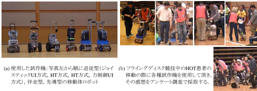
図8 テストに使用した試作機6台とテストの様子
