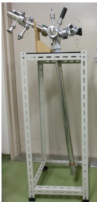
Fig.3. 1 : MCBJ 装置及び計測セットアップ. (a)MCBJ 装置の概念図(b)MCBJ 装置全体像(c) MCBJ 装置先端部(d)計測セットアップ.
