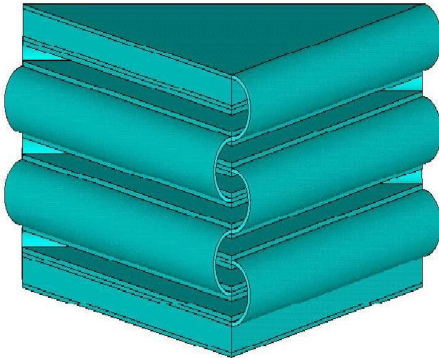
図 5-31 三角形状アクチュエータモデルの外形
