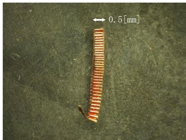
図 A-14  $0.5[\text{mm}]$  サイズアクチュエータ
