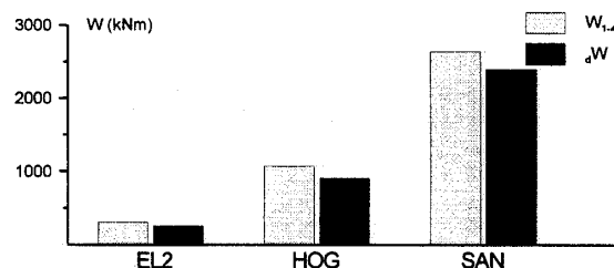
図8 実架構部およびダンパー吸収エネルギー量の比較
