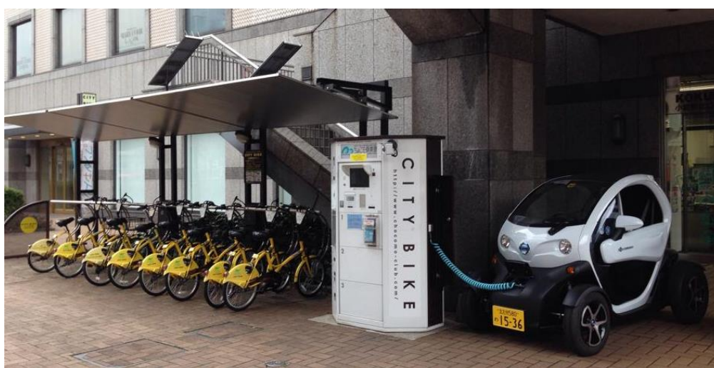
写真 6-7 超小型モビリティのシェア用に改良した電動アシスト自転車シェア・システム
