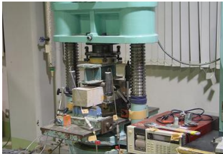
図 5.2 試験状況 (UFC 無筋はり部材の曲げ試験)
