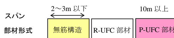
図 1.1 各スパンに適した部材形式(桁部材)
