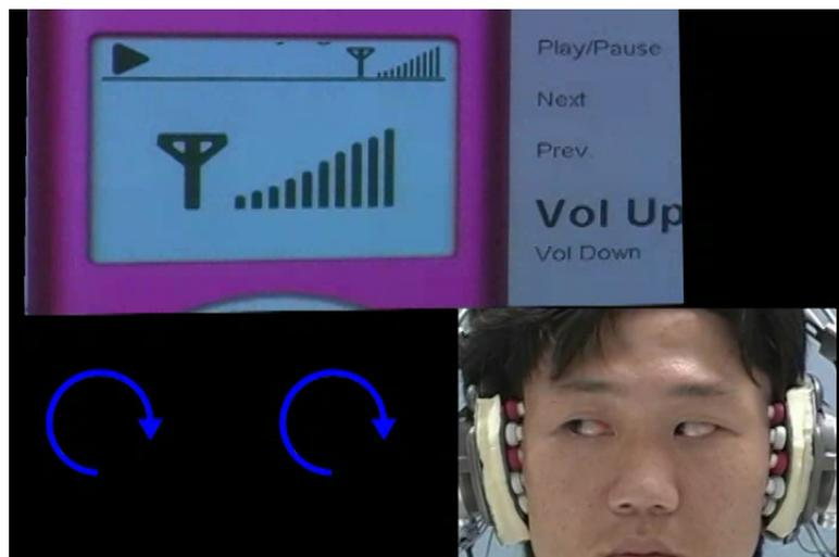
図 5.3: 視線ジェスチャを用いた音楽プレーヤの操作
