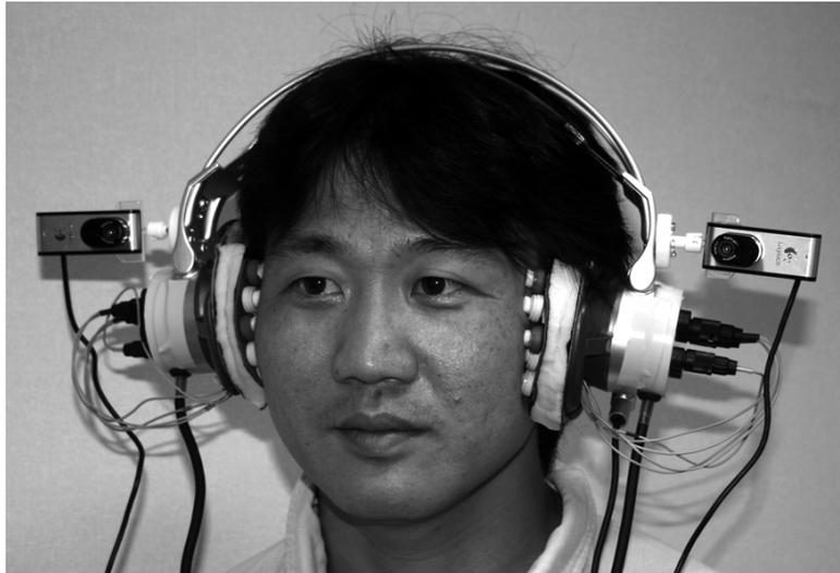
図 3.11: オーバーヘッド型ヘッドホンプロトタイプ
