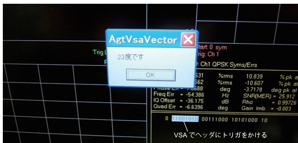
図 5.10: センサ端末から送られた温度データを親機の PC 上で確認する様子
