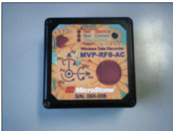
図 4.3：提案手法に用いる 6 軸モーショセンサ
