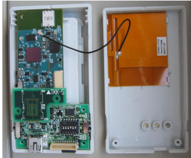
図 3-9 UWB-IR 基地局/センサノードの外観（外付けフィルムアンテナ使用）
