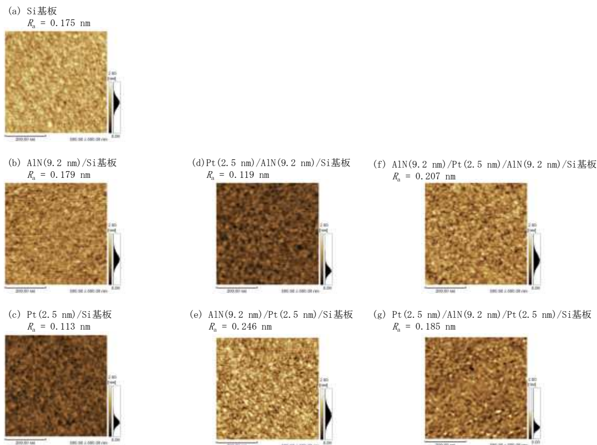
図 3-7 Pt/AlN ナノ多層薄膜の AFM 結果と表面粗さ
