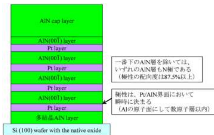
図 5-5 作製した Pt/AIN ナノ多層薄膜中の AIN 層の極性
