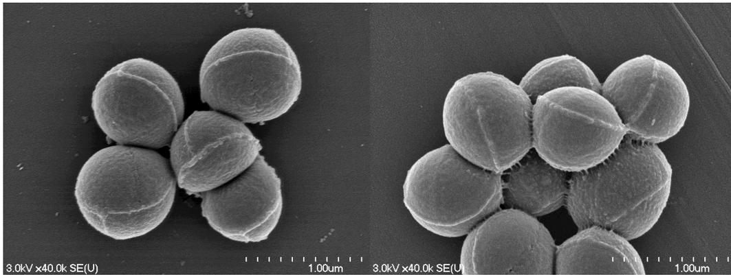
図 5-31 二酸化炭素プラズマ照射した黄色ブドウ球菌(左:10 秒, 右:120 秒)
