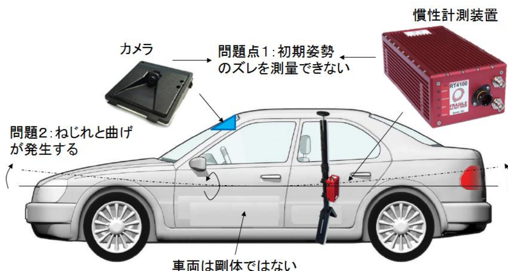
図 4.2： 実用可能な慣性計測装置固定方法
