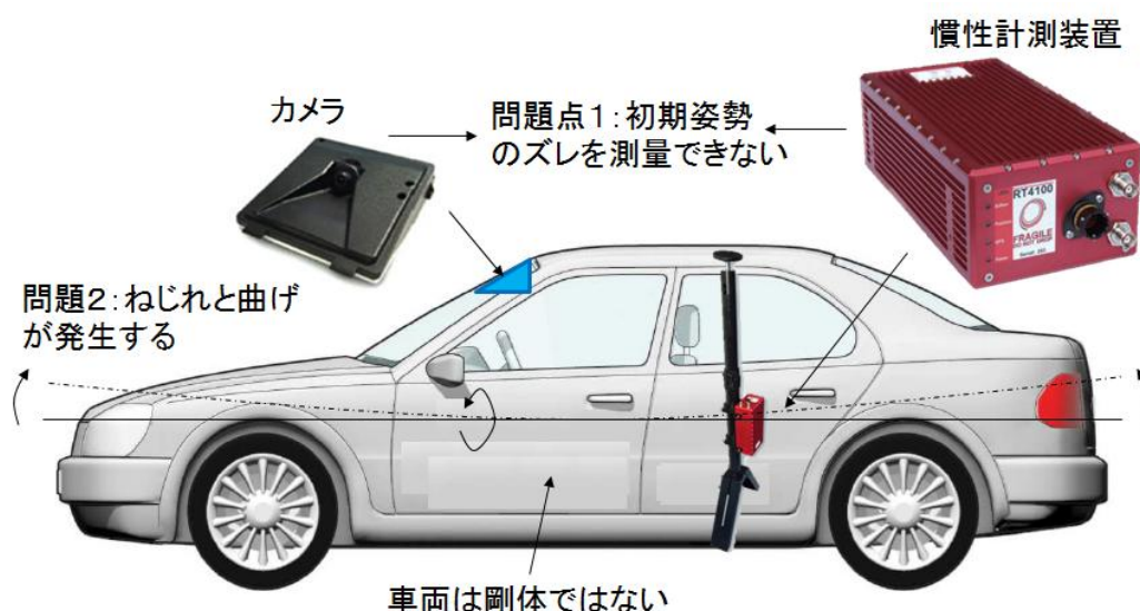
図 4.2 : 実用可能な慣性計測装置固定方法
