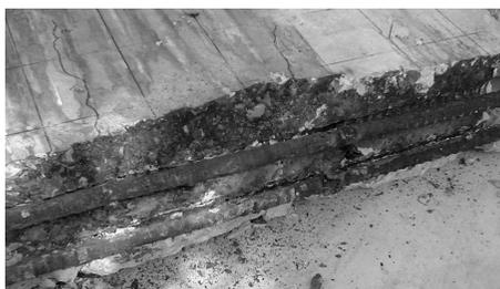
図 4.3-5 電食後における供試体状況(N-144h)
