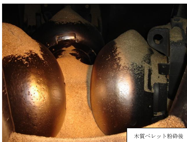
図 2.14 木質ペレット粉碎試験, パージ運転後のミル内部
