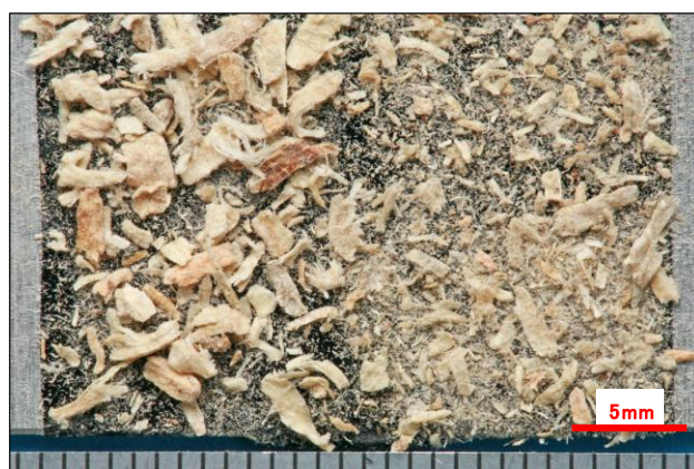
図 2.15 製造木粉の外観写真
