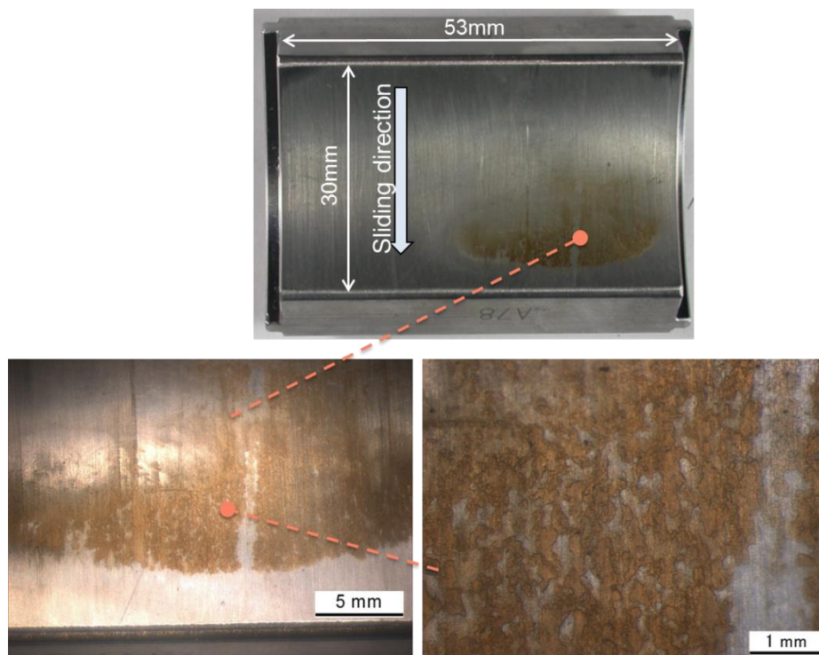
図 5_2 ティルティングパット軸受表面に形成したデポジット例
