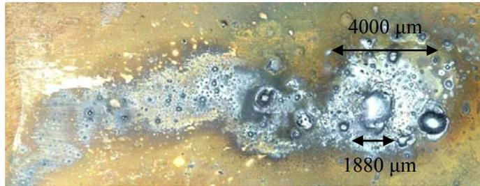
(a) トロリ線表面のアーク痕（上面図）
