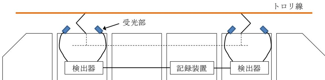
図 2.4.5 光学式離線測定
