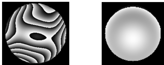
図 4.16 phase wrapping のある例(左)、ない例(右)
