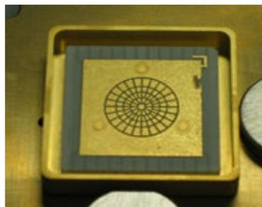
図 2.3 deformable Mirror (トプコン社提供)
