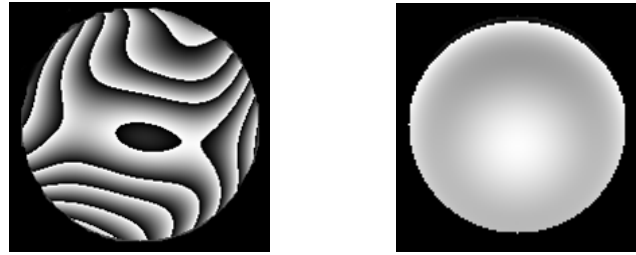
図 4.16 phase wrapping のある例(左)、ない例(右)
