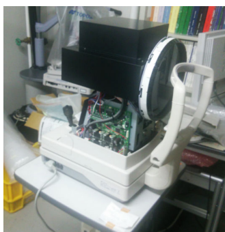
図 5.7 トプコン社製波面センサープロトタイプ機
