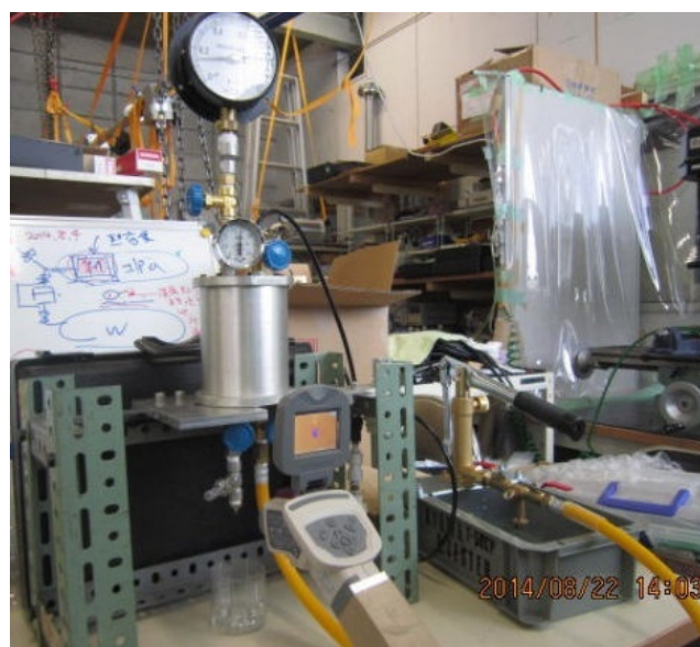
図 3.10 水漏れの実験
