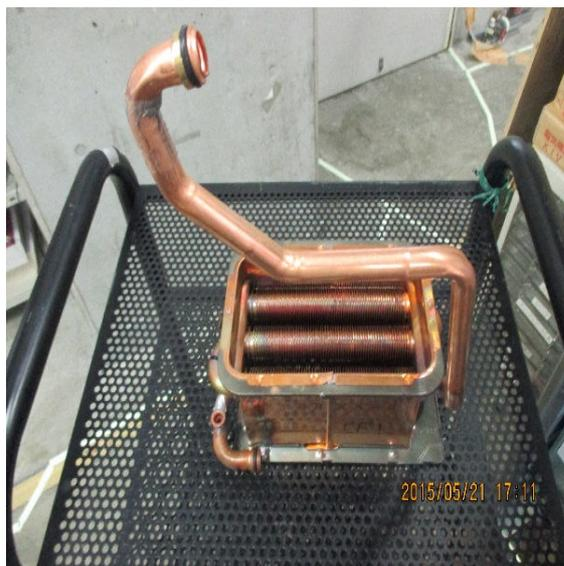
図 5.7 小形熱交換器（銅製，フィン付）
