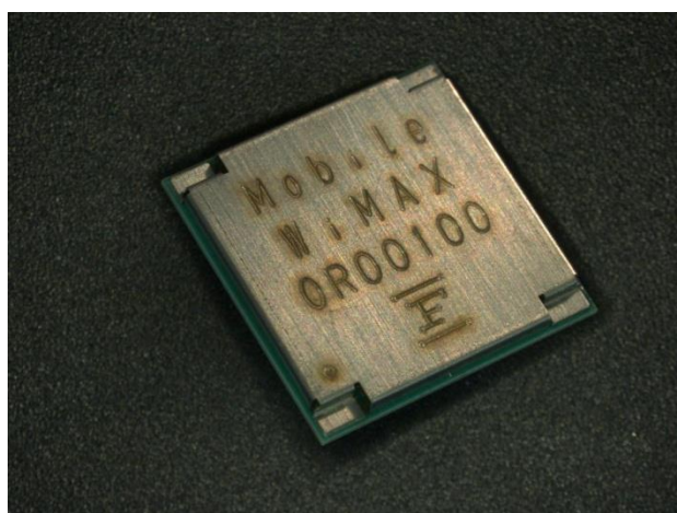
図 4-32 WiMAX MIMO モジュール
