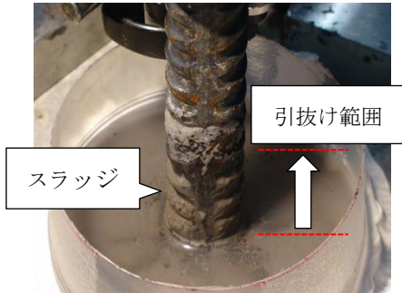
写真3 引抜け破壊(S1)
