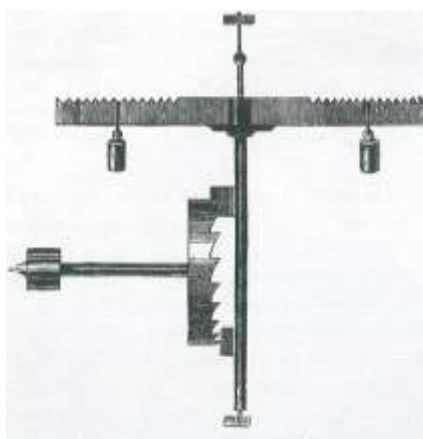
Figure 2.4 バージ脱進機例 124
