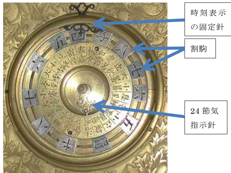
Figure 6.3 和時計面（第1面）拡大図 289
