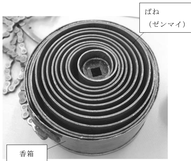
Figure 6.47 ゼンマイ (時方動力,3 代目ゼンマイ) 368
