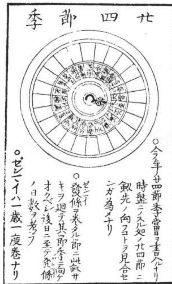
Figure 6.6 万年時計図弁二十四節氣表示板説明部分 292
