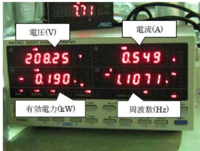
図 4.3-1 発電時の電力計表示
