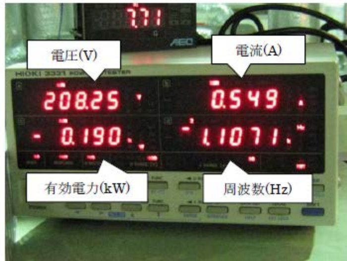
図 4.3-1 発電時の電力計表示
