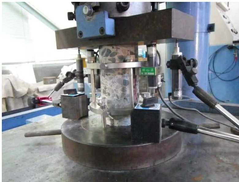
写真 3. 2. 9 コアヤング係数の測定方法
