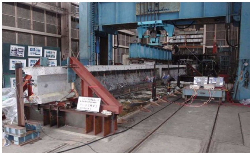
写真 2.2.2 撤去桁 (in 施工技術総合研究所)
