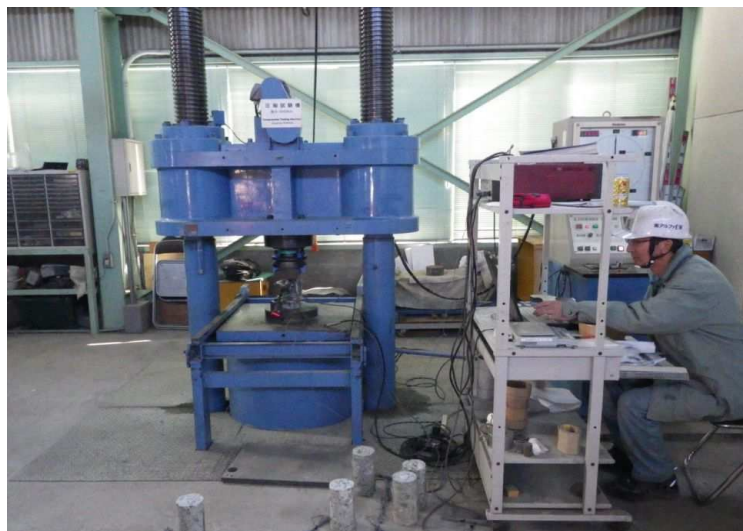
写真 3. 2. 10 コアヤング係数の測定状況
