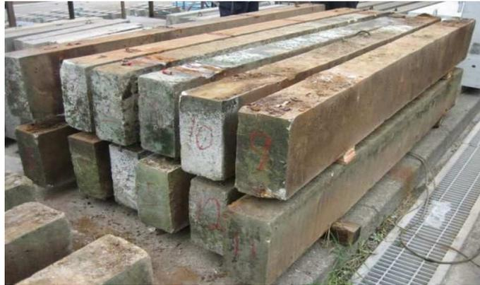
写真 3.3.1 40 年海水暴露供試体
