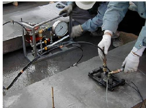
写真 1.2.6 フラットジャッキによる加圧状況
