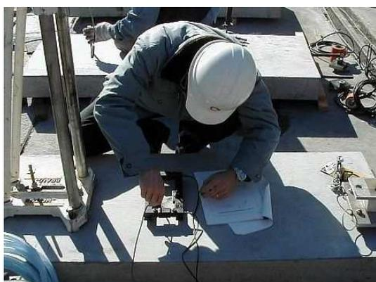
写真 1.2.1 変位計の取付けおよび調整
