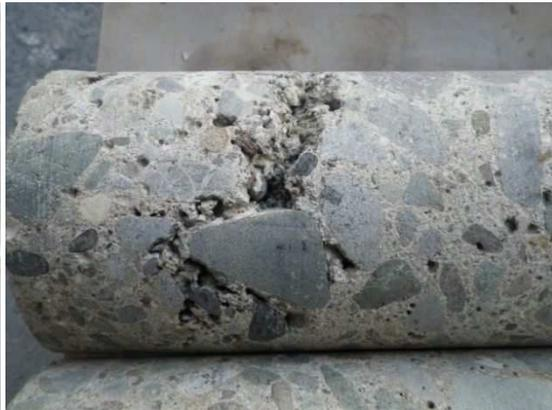
写真 3.2.6 打設時のジャンカ
