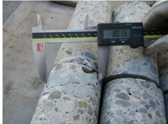
写真 3.2.4 大きい粗骨材 (80mm)
