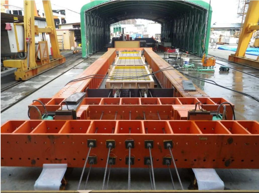
写真 4.3.2 プレテンション鋼材の仮緊張
