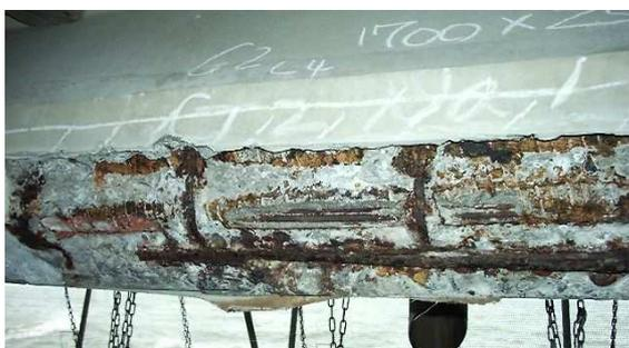
写真 1.1.6 内部の鋼材腐食
