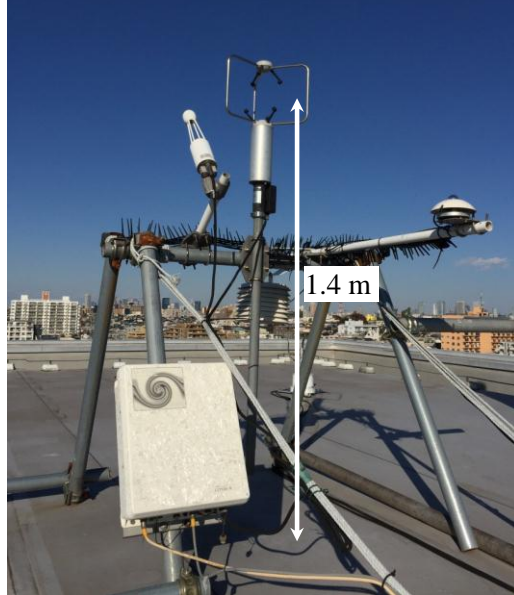
図 2.7 超音波風速計. 東京工業大学緑ヶ丘 1 号館屋上に設置. 超音波風速計は, 地上高 25.0 m, 屋上の屋根面からの高さ 1.4 m
