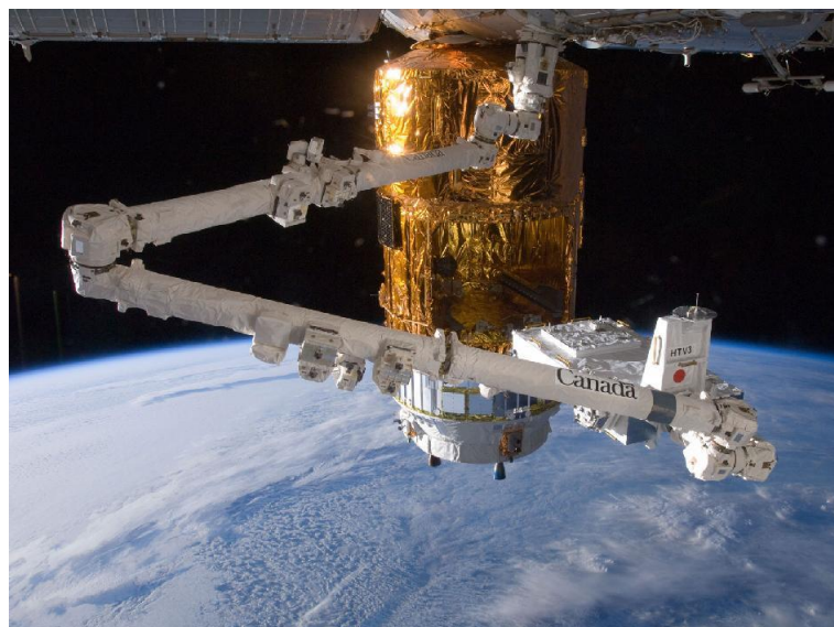
Figure 4-5 HTV になった貨物搭載用パレットを収納する SSRMS ©NASA
