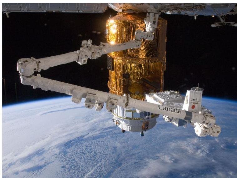
Figure 4-5 HTV に空となった貨物搭載用パレットを収納する SSRMS ©NASA
