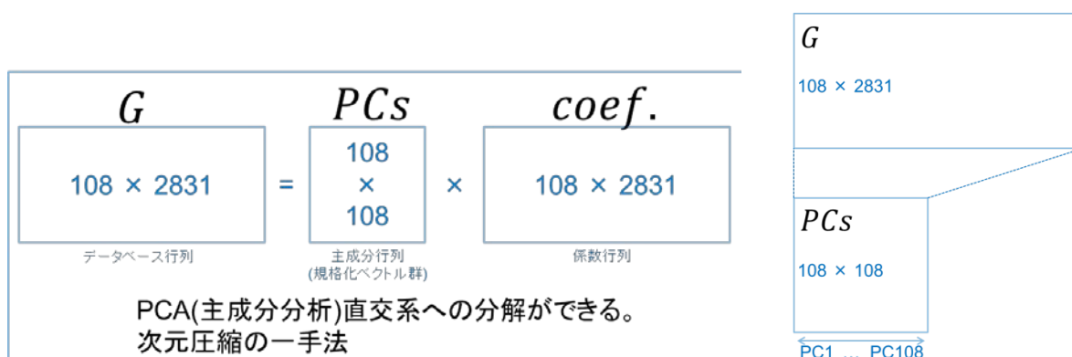
図 5-15. 主成分分析 (PCA)による解析の概念
