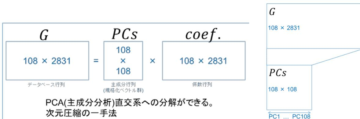
図 5-15. 主成分分析 (PCA)による解析の概念
